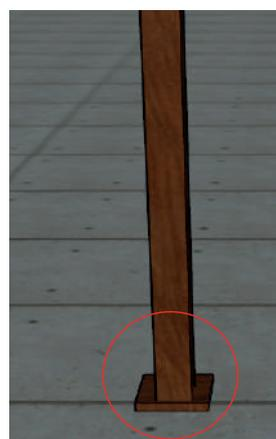
No caso dos pilares em piso: Devem ser travados com barrote parafusados no contra-piso.
