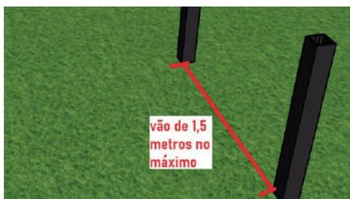
Os Pilaretes serão colocados a cada 1,5 metros no máximo até o comprimento final do deck. Pois a viga a ser colocada sobre eles é que suporta esse vão.
