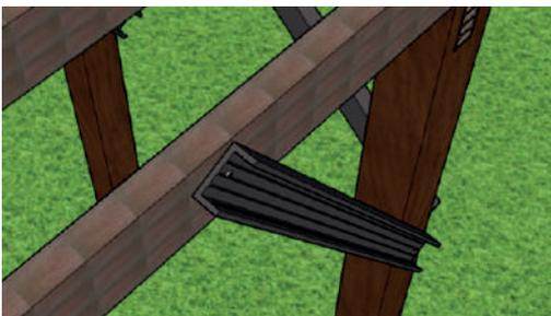
Os pilares devem ser travados às vigas inferiores e superiores adjacentes nas duas direções para evitar o deslocamento da estrutura. O travamento deve ser feito com meio palanque (palanque cortado ao meio) a 45 graus, e fixados com o parafuso francês.
