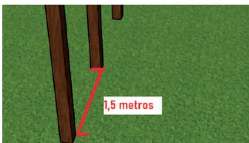
Os Pilares serão colocados a cada 1,5 metros no máximo até o comprimento final do deck. Pois a viga a ser colocada sobre elas é que suporta esse vão.
